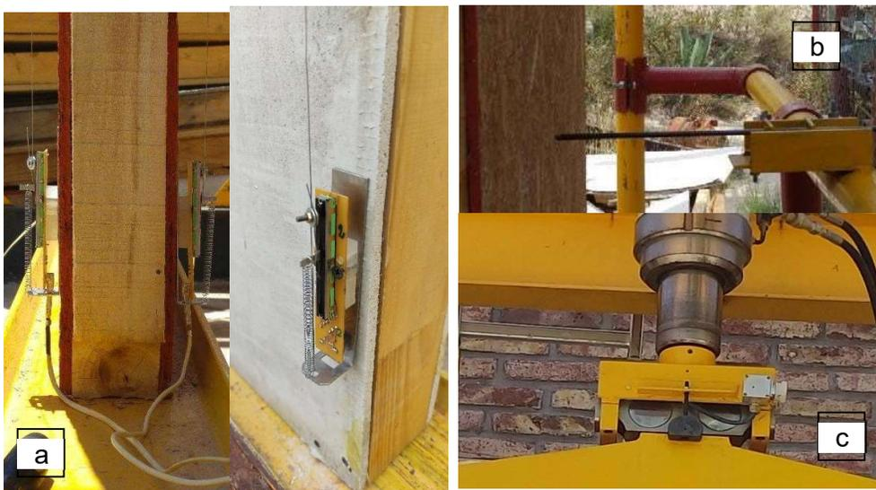
**Figura N° 8: a) Detalles del potenciómetro para medir la deformación longitudinal del panel. b) Detalle de los instrumentos para medir la deflexión central. c) Detalle de la celda de carga**
