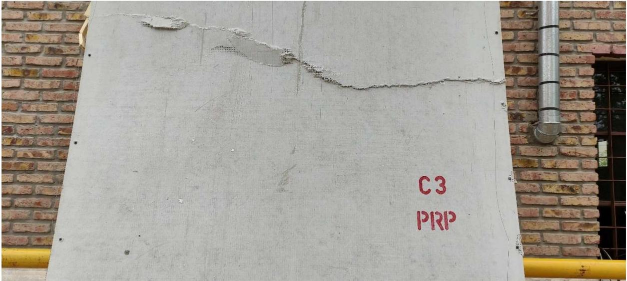
**Carga Característica por compresión en Paneles de composición de placas MGO óxido sulfato de magnesio+ EPS 90 mm + placas MGO óxido sulfato de magnesio**
