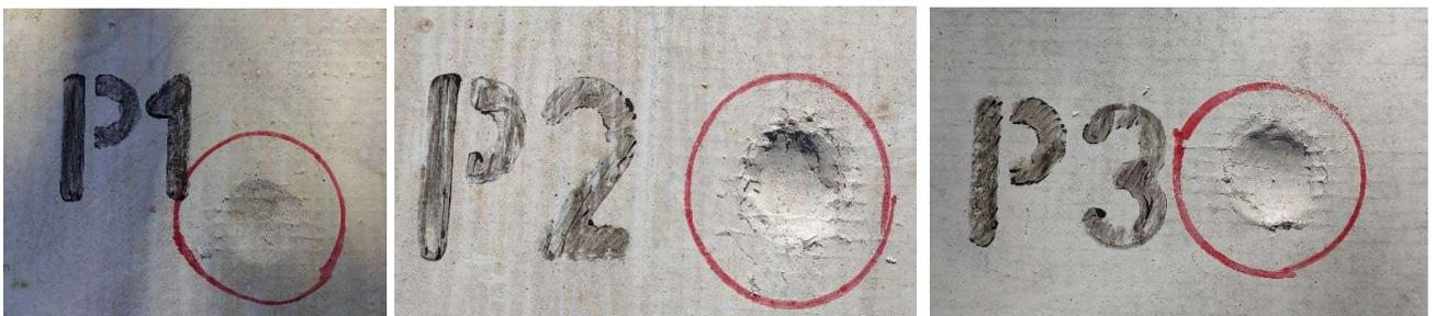
**Figura N° 8: Representación gráfica del Método de Ensayo de Resistencia al impacto de la bola de acero y fotografía de sus improntas**
