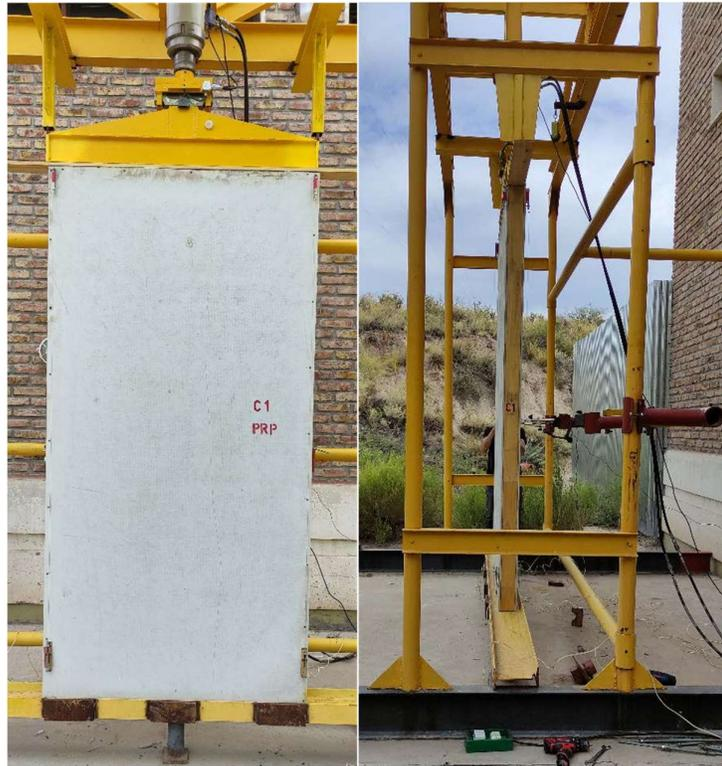
**Figura N°11: Vista general del ensayo de compresión.**
