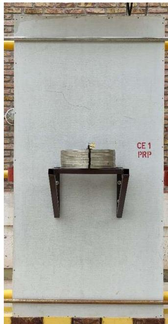
**Figura N° 10: Fotos de los ensayos de carga excéntrica**
